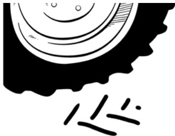
1,6 bar Reifendruck = 2.050 cm 2 Bodenkontakt
